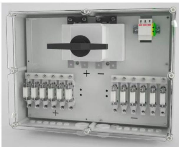
La scatola di stringhe serve anche come protezione contro le sovracorrenti inverse attraverso i fusibili installati sia sul polo positivo che sul polo negativo. Al suo interno sono poi installati gli scaricatori di sovratensioni e un sezionatore del carico all'uscita. Le scatole devono essere dotate di un sistema di monitoraggio della corrente di stringa, che deve rilevare i guasti con i relativi segnali di allarme.
