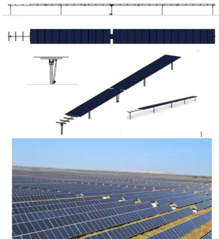
*Figura 2-3 Modello 3D e fotografie esemplificative dei trackers utilizzati nel progetto*
