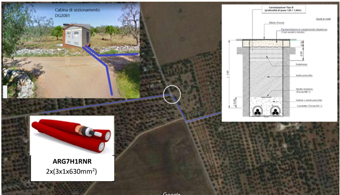
Fig. 6: Percorso su banchina della Strada comunale e connessione su cabina di sezionamento
