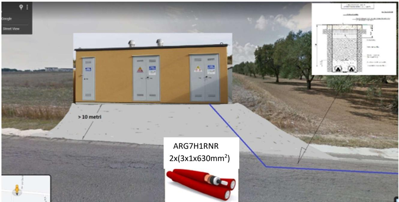
Fig. 4a: Partenza del percorso cavidotto in MT
