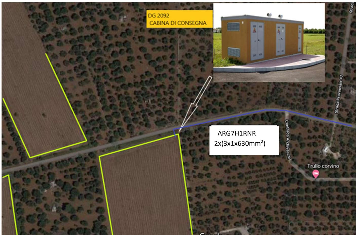
Fig. 4b: Partenza del percorso cavidotto interrato dalla Cabina di consegna DG2092
