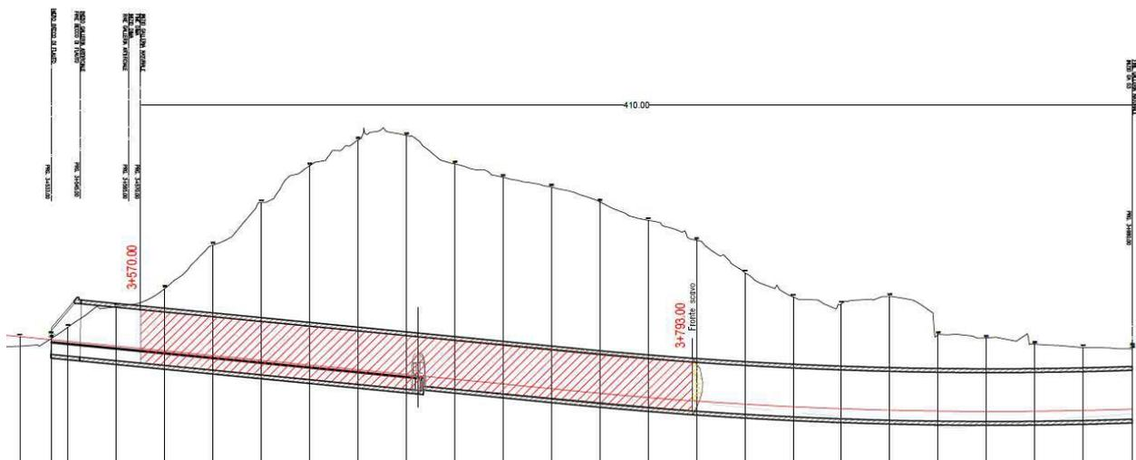
**Figura 3: - Galleria Naturale Fornaci I– stato avanzamento dello scavo (in rosso il tratto realizzato)**
