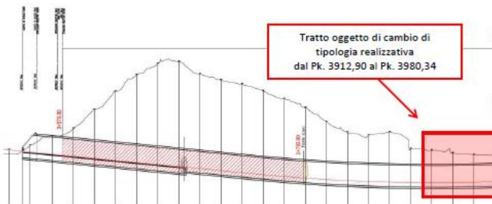
Figura 9: - Profilo longitudinale originario con evidenza del tratto oggetto di variazione tipologica
