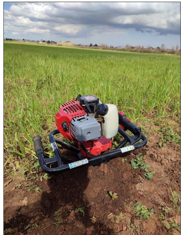
**Fig. 16** – Scavo con mototrivella.
