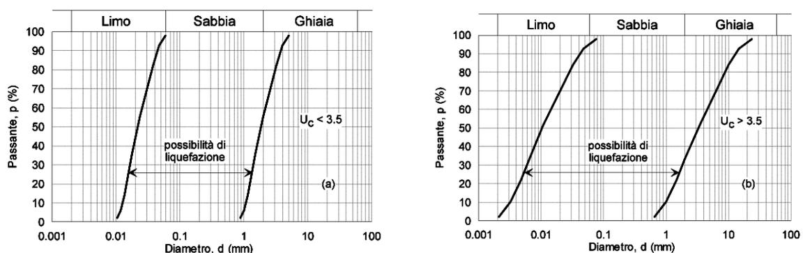
Fig.24 – Fusi granulometrici di terreni suscettibili di liquefazione
