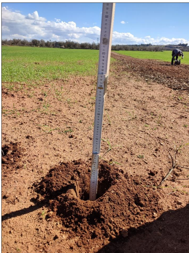
Fig. 05 – Scavo con mototrivella in cui si evidenzia la profondità minima (0.20ml dal p.c. PZ6) e massima raggiunta (0.80ml dal p.c. PZ5).
