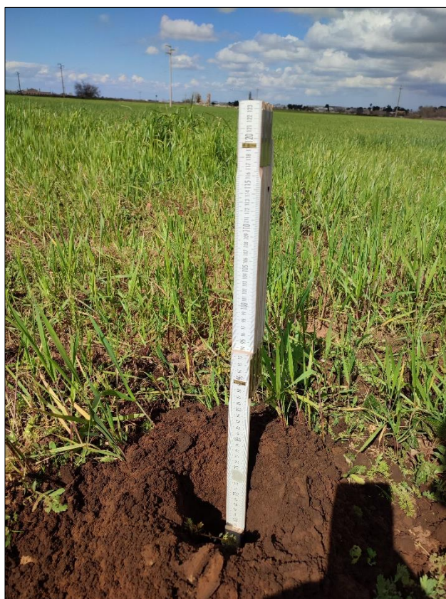
Fig. 05 – Scavo con mototrivella in cui si evidenzia la profondità minima (0.20ml dal p.c. PZ6) e massima raggiunta (0.80ml dal p.c. PZ5).
