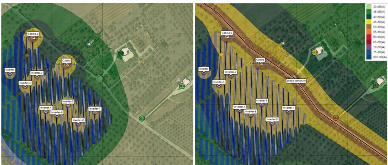
Fig. 18/18a – Studio di propagazione sonora di tutte le sorgenti presso ricettore PRC_6 – Planimetria EMISSIONE / IMMISSIONE
