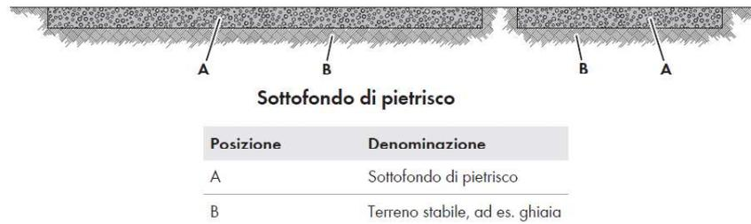
Figura 10 - Schematizzazione del basamento.
