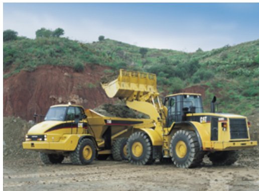
Fig. 7.6.B Esempio di pala meccanica da circa 200 kW
