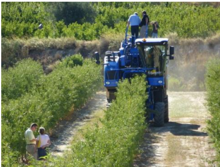
Macchina scavallatrice durante le operazioni di raccolta in mandorleto superintensivo a siepone
