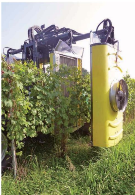
pompa irroratrice a polverizzazione pneumatica con diffusore anti-deriva
