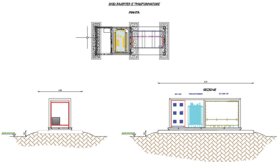
Scavo di sbancamento per posizionamento cabina di Consegna: 6.75 ml x 2.7 ml x 0.50 h I metri cubi di scavo equivalgono a 9.11 m<sup>3</sup>. All'interno dei campi sono ubicate 5 cabine, per un totale di 45.56 m<sup>3</sup>.
