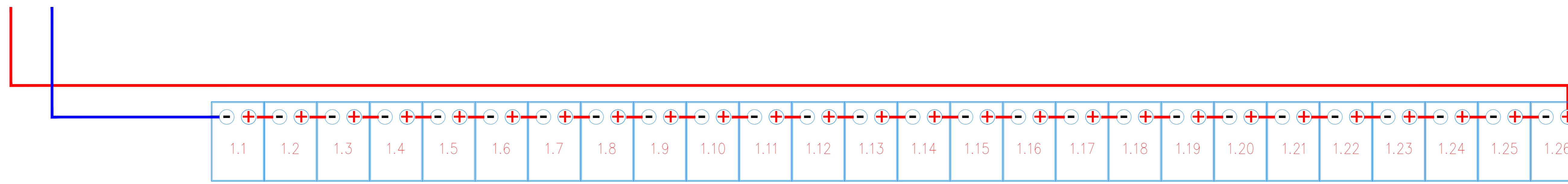
Particolare di cablaggio n° 1 stringa da 26 moduli
