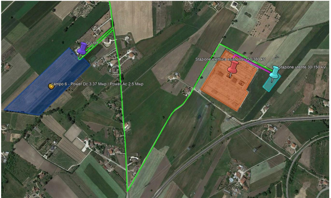
Fig.1.3 - Percorso linea MT da QG-MT a SSU e percorso linea AT da SSU a SE Benevento
