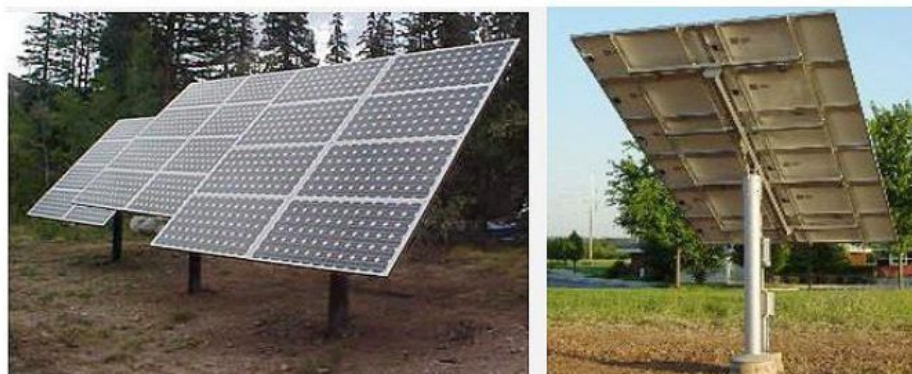
Figura 3.1-2 Inseguitori di Tilt
