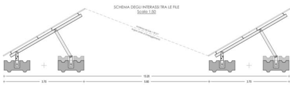
Figura 8: schema moduli fotovoltaici dei Campi 2 e 8
