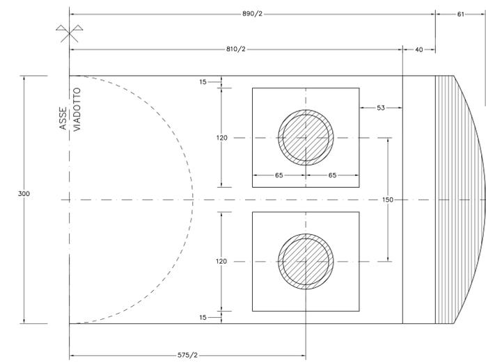
PIANTA PULVINO PILE N°14-15-17÷22 SCALA 1:25
