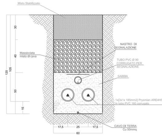
Sezione tipo doppia terna lungo strada asfaltata
