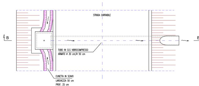
SEZIONE TIPO CON POZZETTO DI SCOLO
