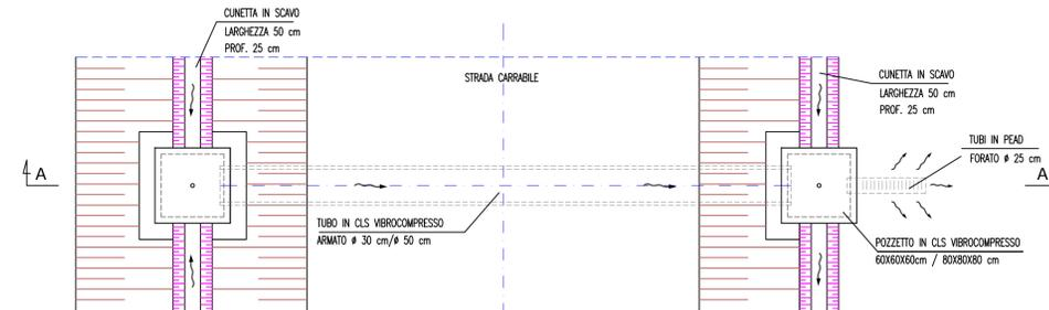
SEZIONE TIPO CON TUBO DI SCOLO Ø30/Ø50
