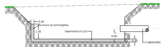
Particolare struttura di ancoraggio alla tubazione
