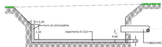
Particolare struttura di ancoraggio alla tubazione
