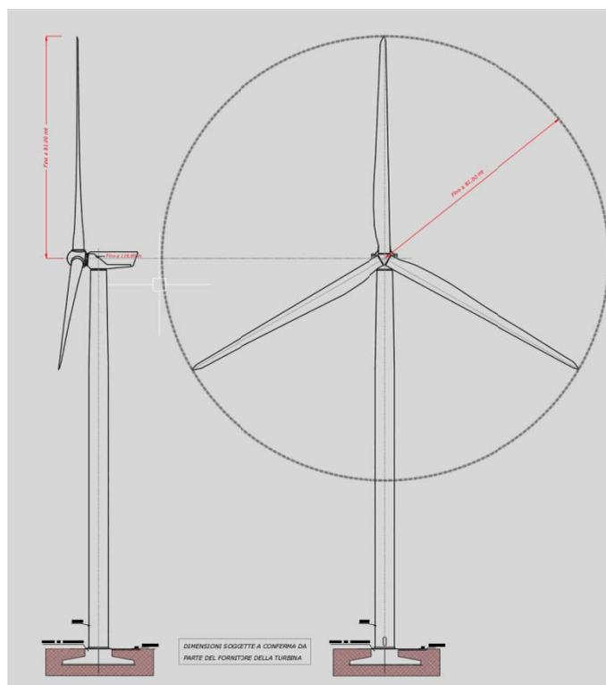
**Figura 1.4.1.-1.: Caratteristiche geometriche del modello di turbina eolica VESTAS V162 da 6,0 MW**
