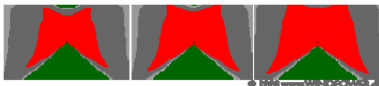
Figura 1.3.1.3.-2.: La dimensione dell'ombra del rotore e il numero dei minuti d'ombra all'anno nelle vicinanze della turbina variano in proporzione alla zona del rotore.
