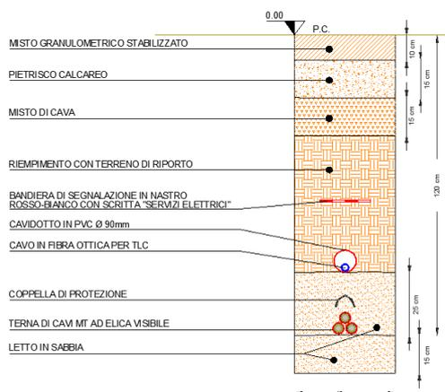
*Fig. 6 –Sezione di scavo per la posa del cavidotto su strada esistente*
