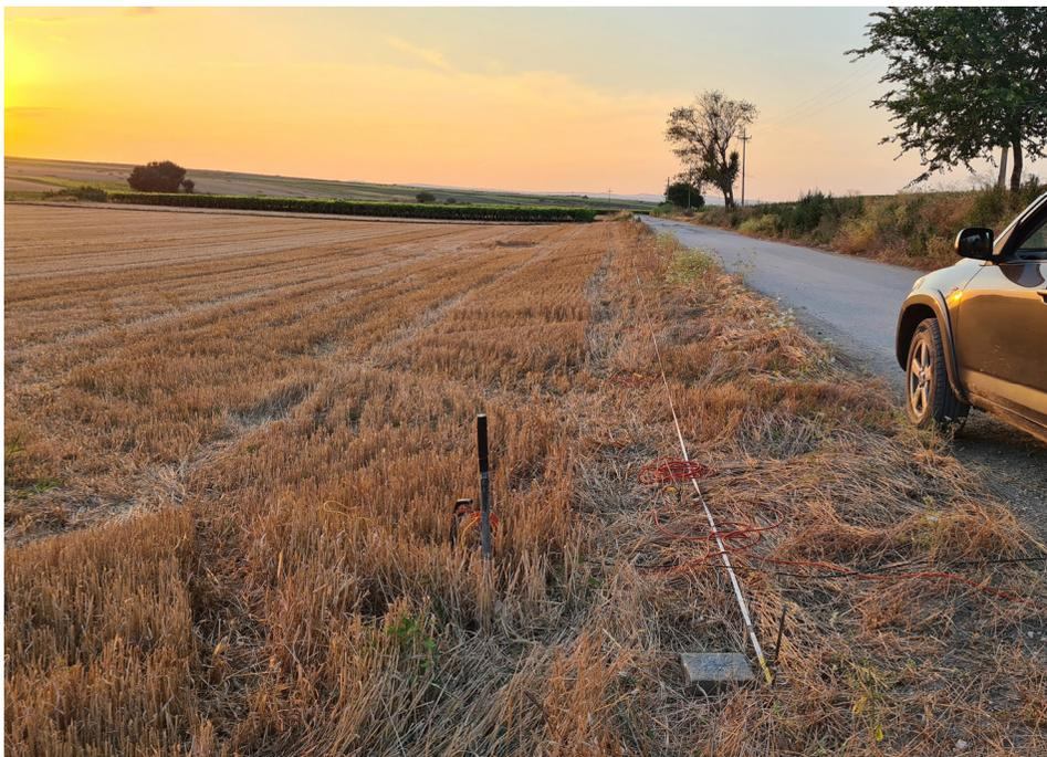
*Particolare Prospezione Sismica a Rifrazione*
