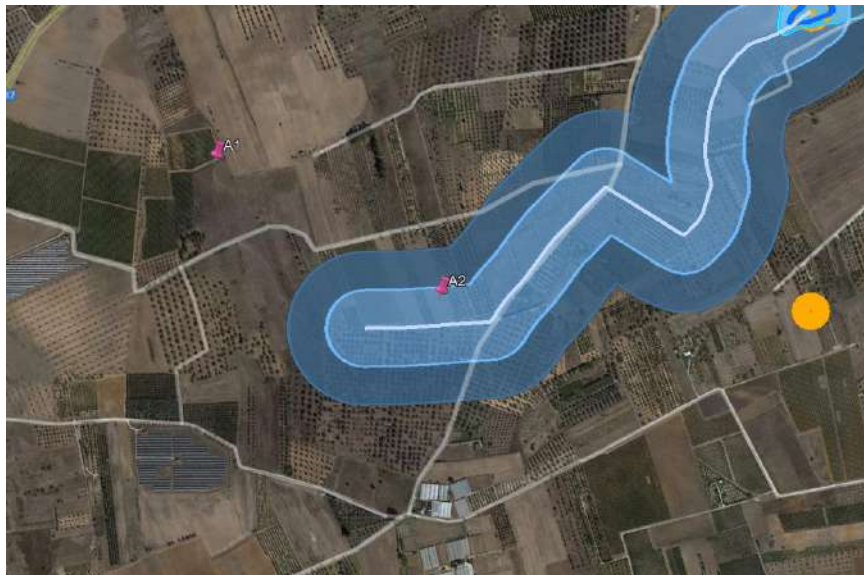
Figura 4: individuazione posizione originaria della torre A2 nel vincolo PAI: buffer 75 m da reticolo idrografico
