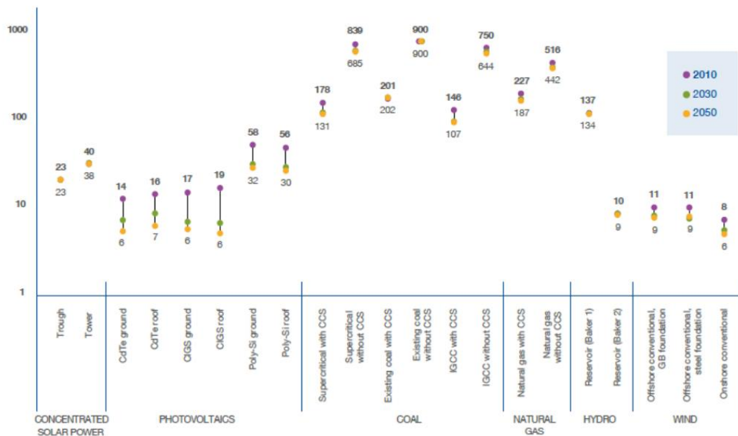
Figura 7: Emissioni di gas ad effetto serra (in gCO2eq/kWh) nell'intero ciclo di vita di diverse tipologie di impianto. I numeri per gli anni futuri riflettono la riduzione delle emissioni dovuta al progresso tecnologico ipotizzabile (Fonte: Dodd N., Espinosa N., 2021 – Report JRC)
