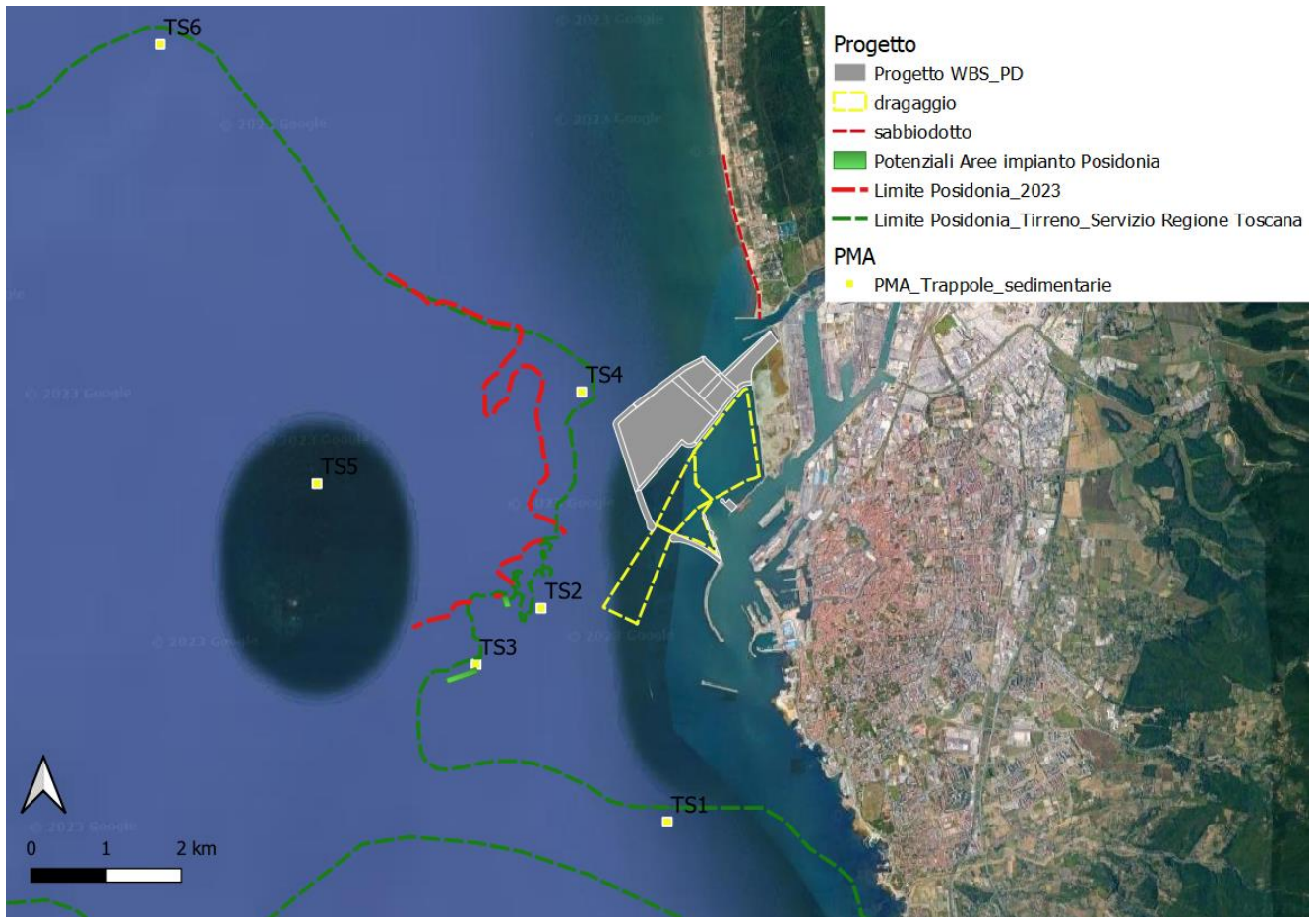
Figura 6: planimetria con il posizionamento delle trappole sedimentarie
