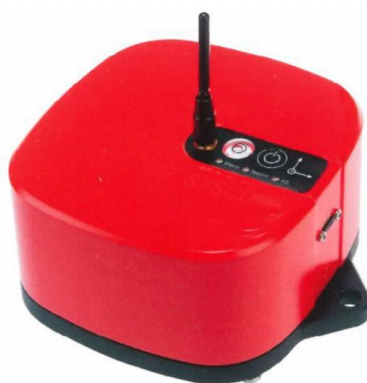
Figura 9 – Esempio di sistema autonomo di monitoraggio delle vibrazioni
