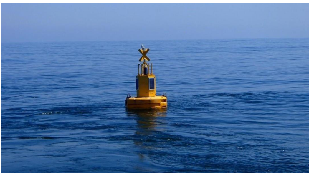
Figura 4: boa con torbidimetro e pannello solare tipo
