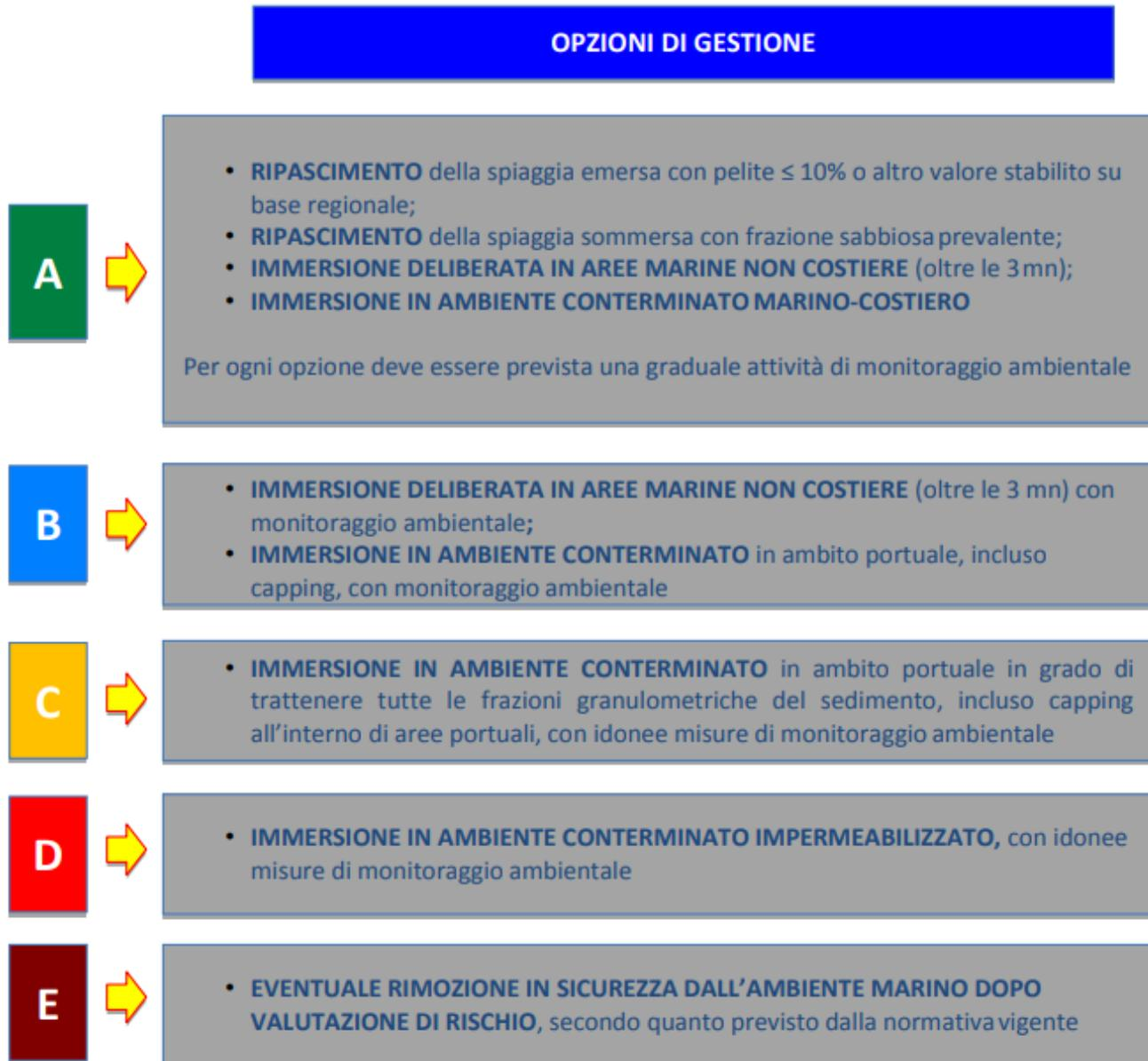
Figura 37: Opzioni di gestione compatibili con la classificazione di qualità dei materiali da dragare (estratto da Allegato tecnico al DM 173/2016)
