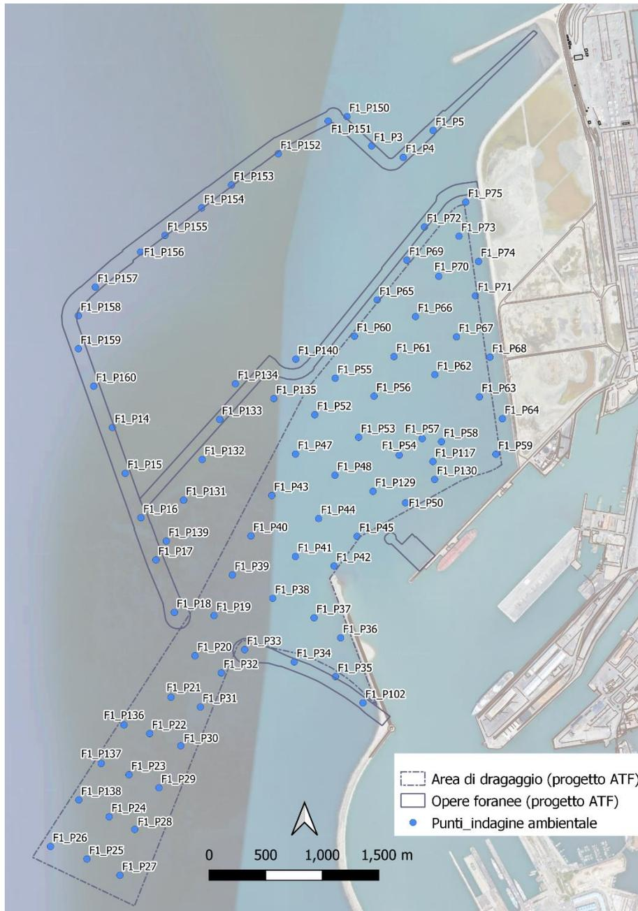
Figura 26: Ubicazione dei punti di indagine in corrispondenza delle aree che saranno scavate (per imbasamento opere e per dragaggi)
