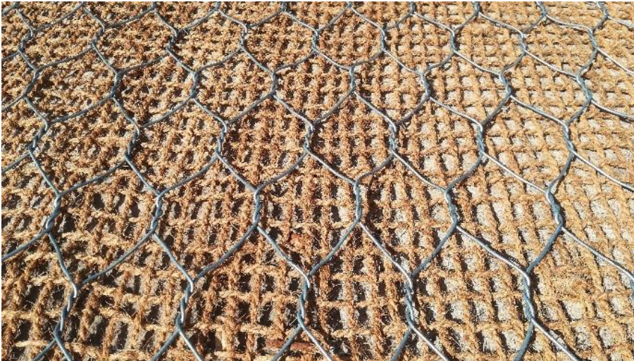
Figura 22 Dettaglio dei geocompositi "R.E.C.S.® - Cocco"
