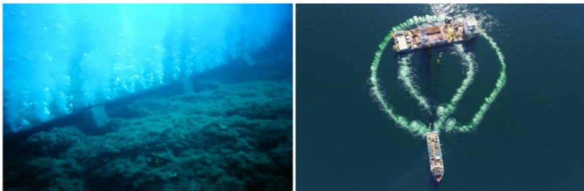
Figura 3.18: Zone con cortina di bolle rilasciata da un tubo perforato poggiato sul fondo (sinistra) e doppia cortina di bolle utilizzata intorno ad una imbarcazione (a destra) (© hydrotechnik lübeck gmbh) <https://www.offnoise-solutions.com/the-hydro-sound-damper-system-hsd-system/>
