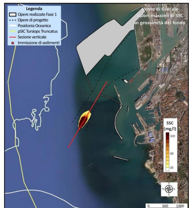
Figura 5.27 - Vento di Grecale, dragaggio del canale di ingresso con draga CSD.
