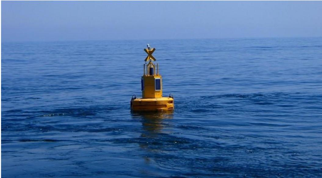
*Figura 16: boa con torbidimetro e pannello solare tipo*
