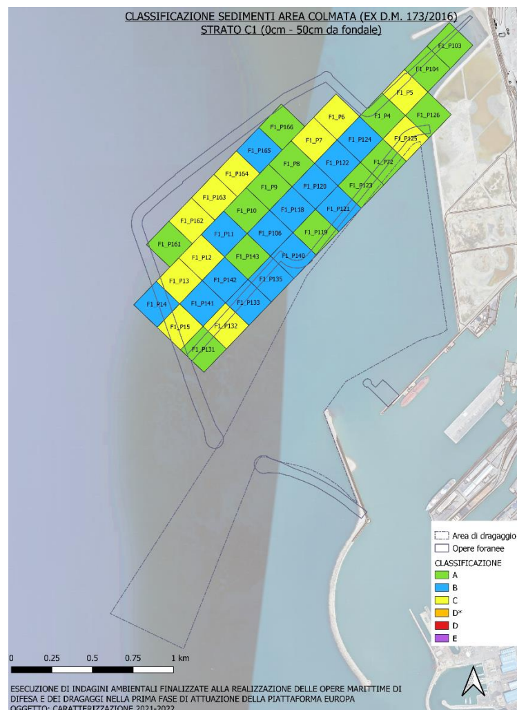
Figura 37: classi di qualità dei campioni di sedimento in funzione delle ipotesi di gestione – livello C1 – area di colmata
