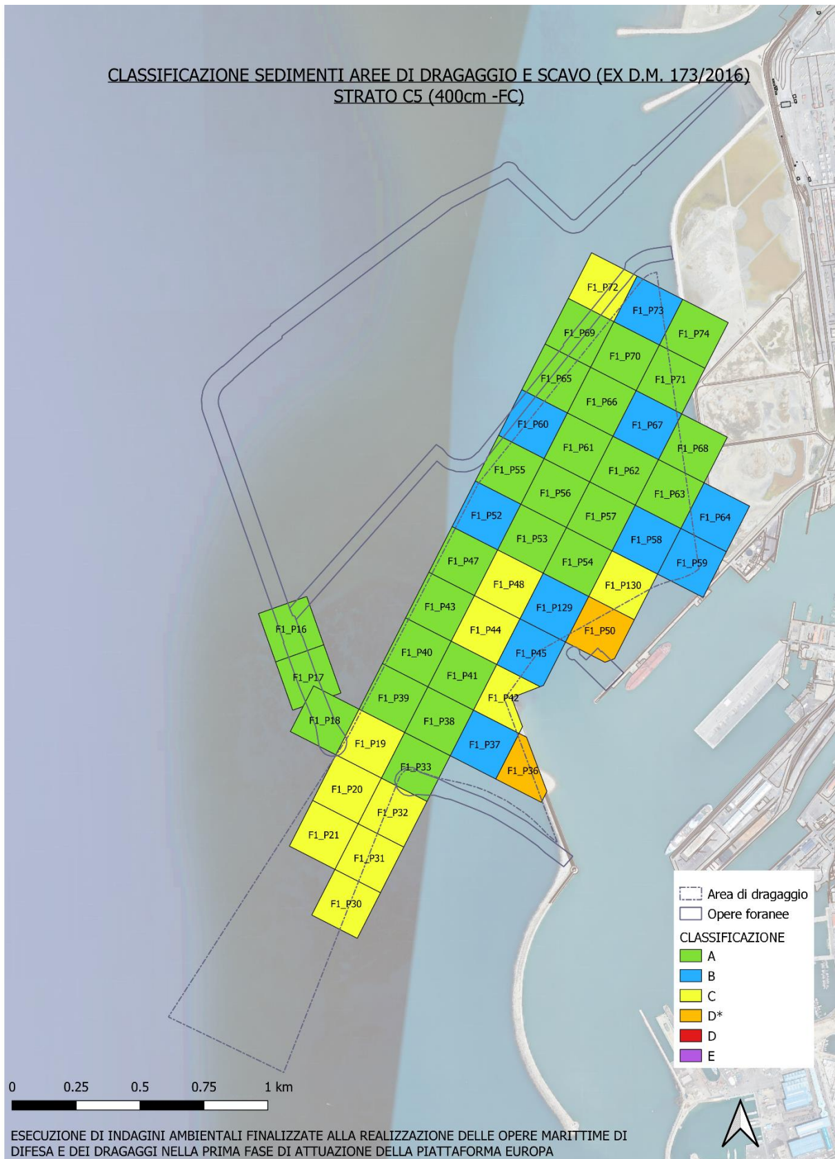
Figura 36: classi di qualità dei campioni di sedimento in funzione delle ipotesi di gestione – livello C5
