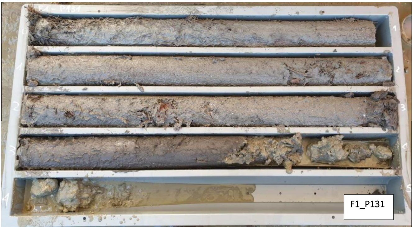
Figura 23: Cassette catalogatrici dei sondaggi F1_P60 e F1_P131: si osservano abbondanti resti algali di Posidonia frammista al sedimento fino a 4 – 5 m di profondità
