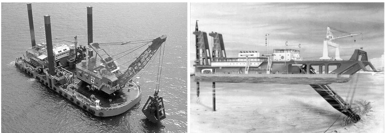
Figura 42 Draghe a benna del tipo a fune (a sinistra) e aspirante refluyente stazionaria (CSD, a destra)
