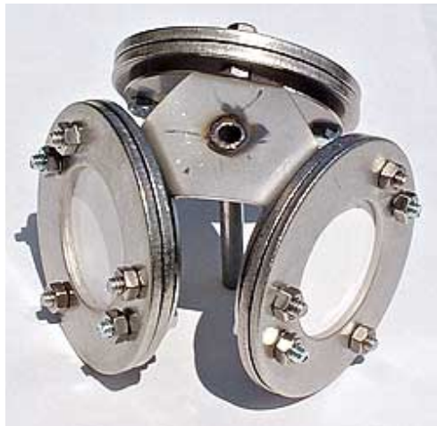
Fig. 7 - Supporto in acciaio inossidabile contenente tre POCIS
