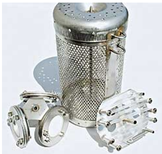
Fig. 8 – Supporto in acciaio inossidabile per Silicone Rubber Strip e POCIS
