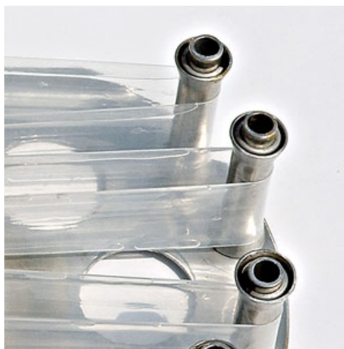
Fig. 6 - Supporto per Silicone Rubber Strip
