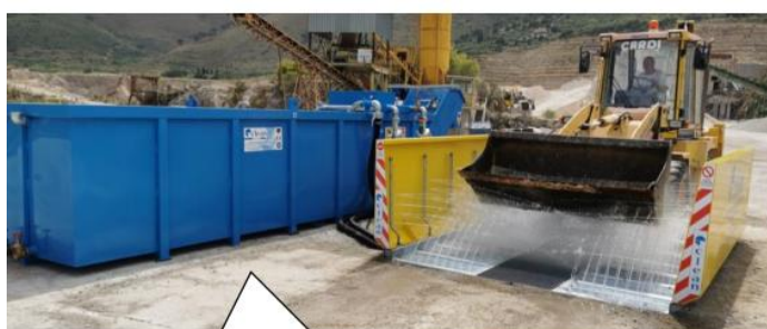
Vasca di chiarificazione mod. VP-40R
