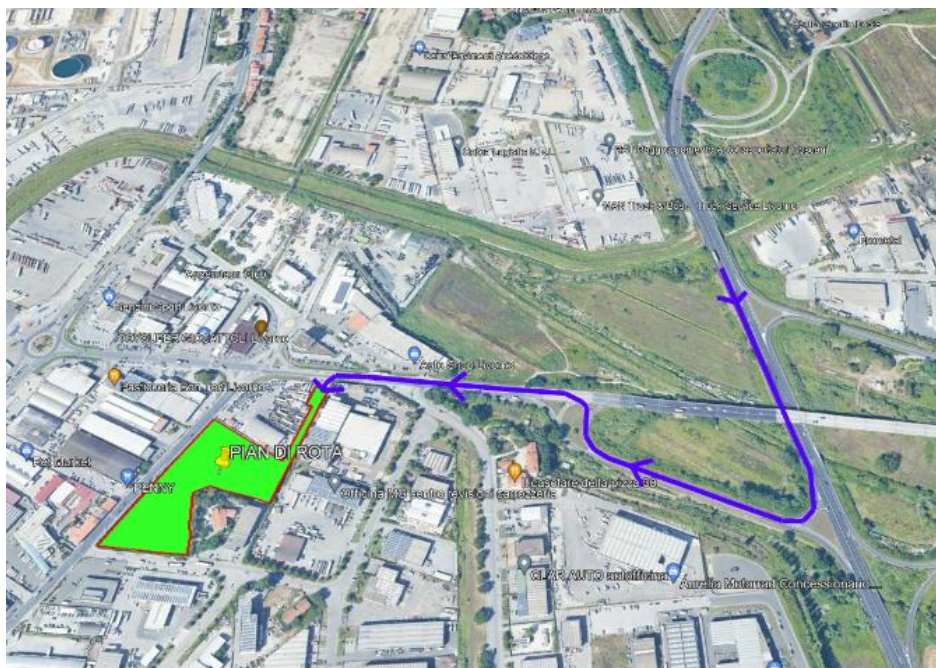
Figura 4: percorso dei mazzi per l'approvvigionamento del calcestruzzo
