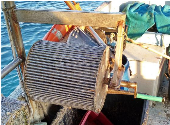
Figura 4.3.6. Esempi di vagli utilizzati per separare le telline di taglia commerciale dal resto del materiale che viene raccolto nel rastrello.
