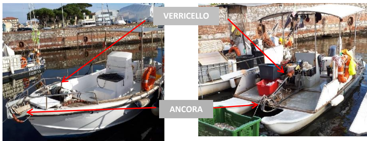
Figura. 4.3.2. Esempi di gozzo (sinistra) e pattino (destra), entrambi in vetroresina, e rispettivi posizionamenti dell'ancora e del verricello.
