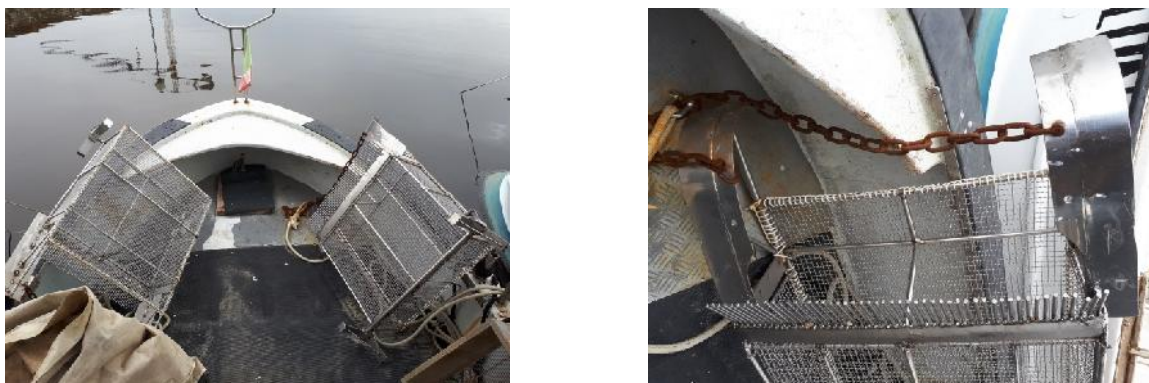
Figura 4.3.3. A sinistra: rastrelli posizionati a poppa di un gozzo in legno; a destra: dettaglio dell'imboccatura di un rastrello con denti e slitte laterali.
