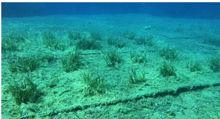
Figura 27: Geocomposito R.E.C.S.® - Cocco in situ ad un anno dal trapianto presso il Comune di Rio (Isola d'Elba, LI)
