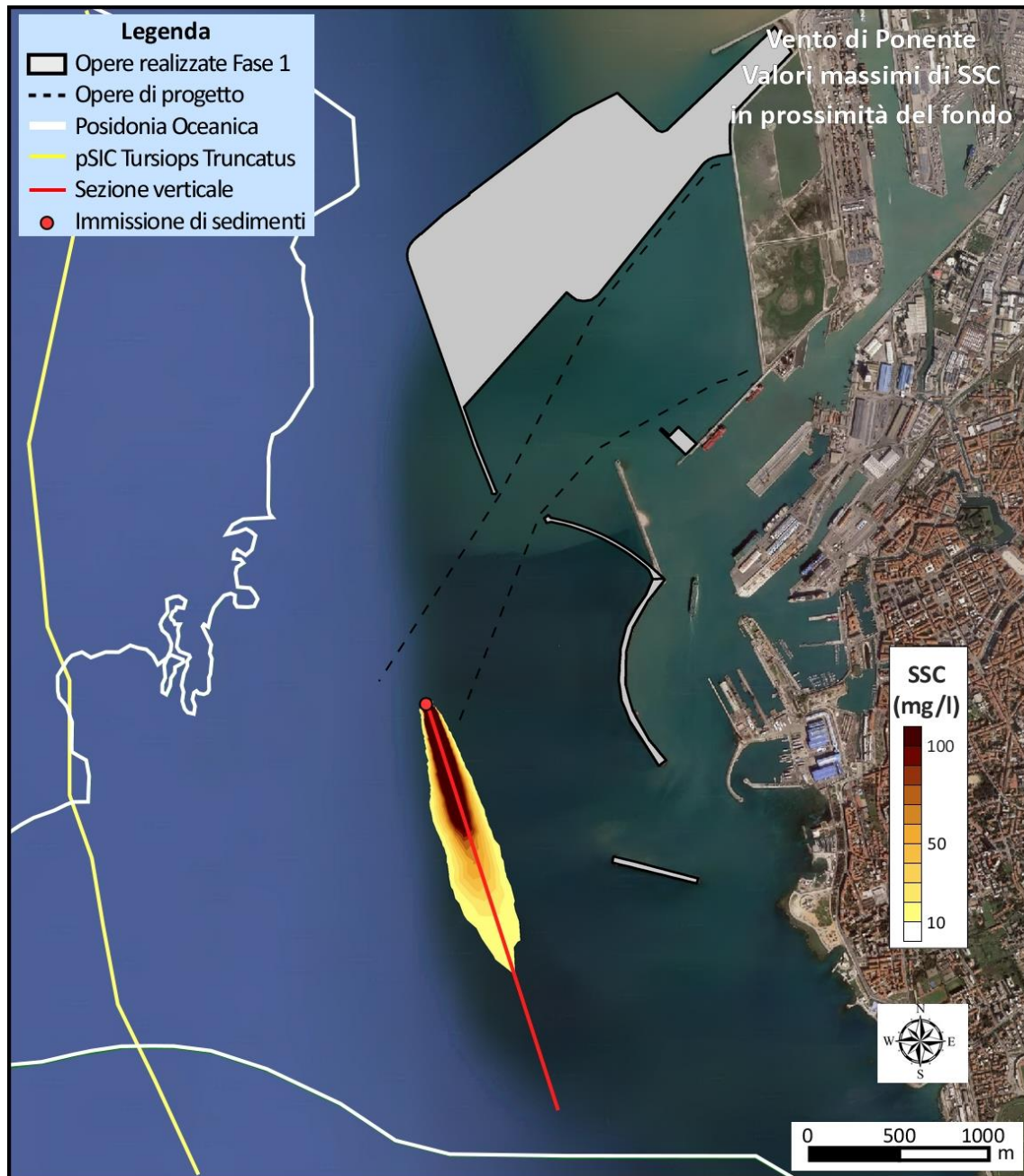
Figura 5.32 - Vento di Ponente, dragaggio del canale di ingresso con draga CSD. Inviluppo della massima concentrazione di sedimenti in sospensione (planimetria)
