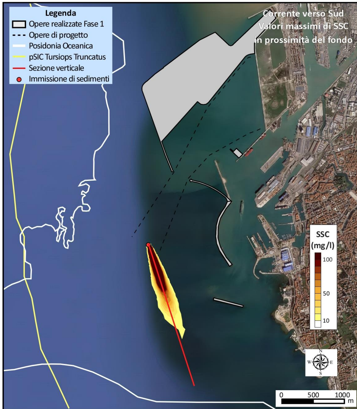
Figura 5.37 - Corrente diretta verso Sud, dragaggio del canale di ingresso con draga CSD. Inviluppo della massima concentrazione di sedimenti in sospensione (planimetria)
