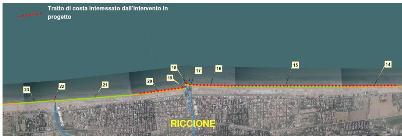
Figura 2.1 – Sviluppo planimetrico del sabbiodotto di Riccione
