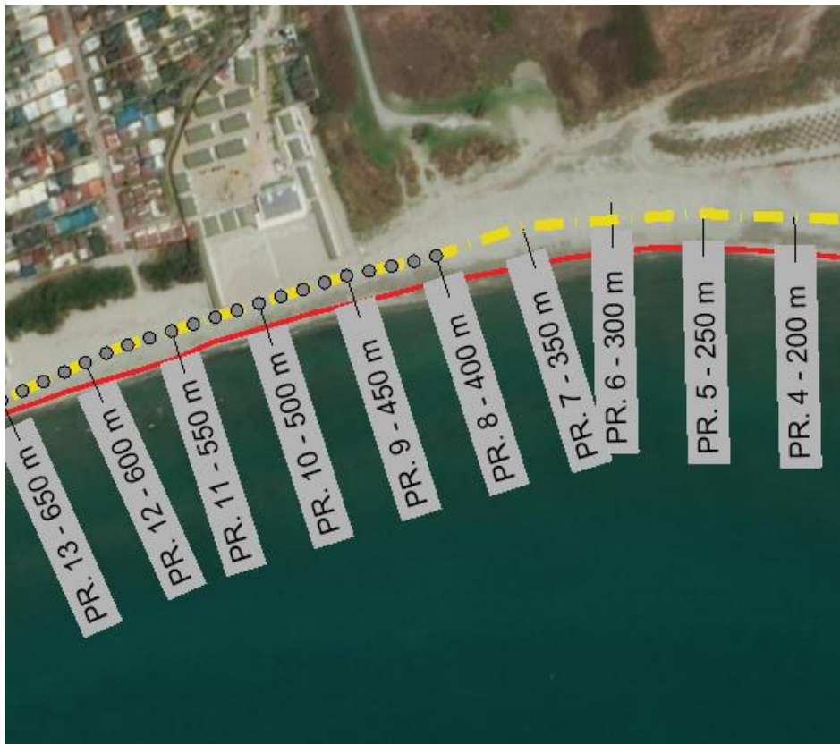
Figura 2.8 – Tracciato del sabbiodotto dalla progressiva 200 m fino alla 650 m. In grigio la localizzazione dei sacchi zavorrati con passo di 12.5 m.
