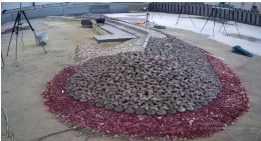
Fig.5: Modellazione fisica 3D presso la vasca del laboratorio EUMER di UniSalento
