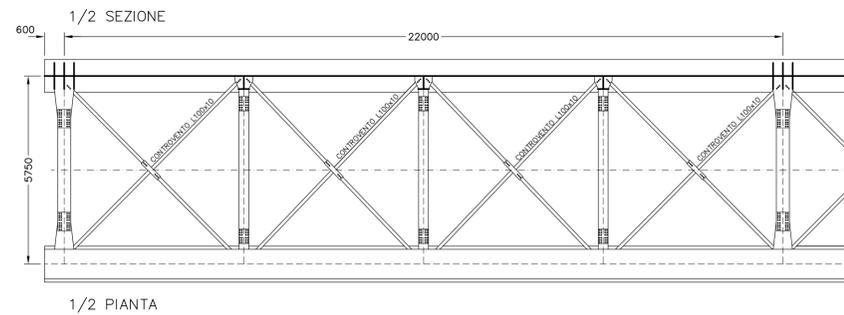
SEZIONE LONGITUDINALE CAMPATA 1 L=22m SCALA 1:100
