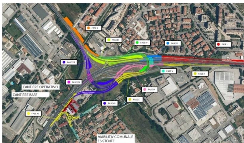
Fig. 5 – Layout e fasi di cantiere (Fonte: Allegati alla Lista di controllo)
