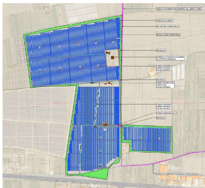
Fig.3: Layout impianto campo 2 sud
