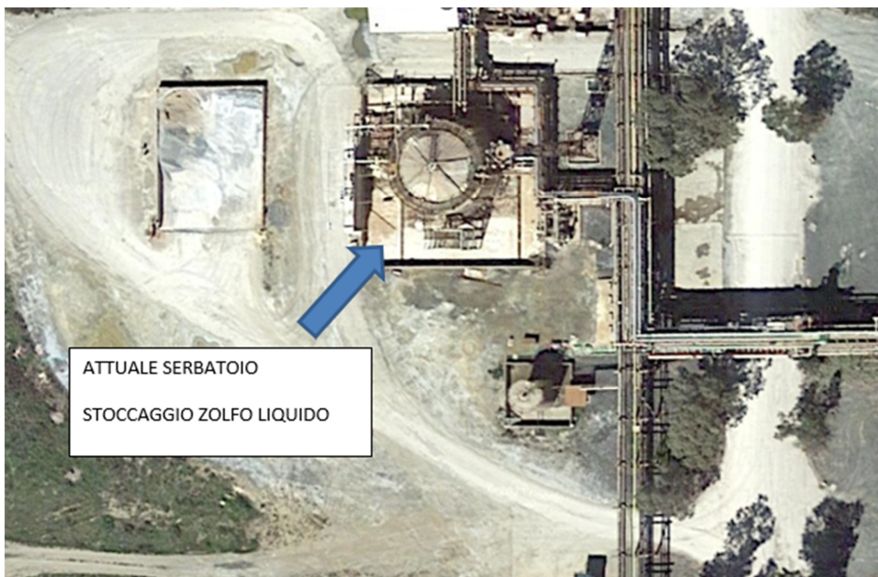
Serbatoio zolfo liquido e bacino di contenimento
