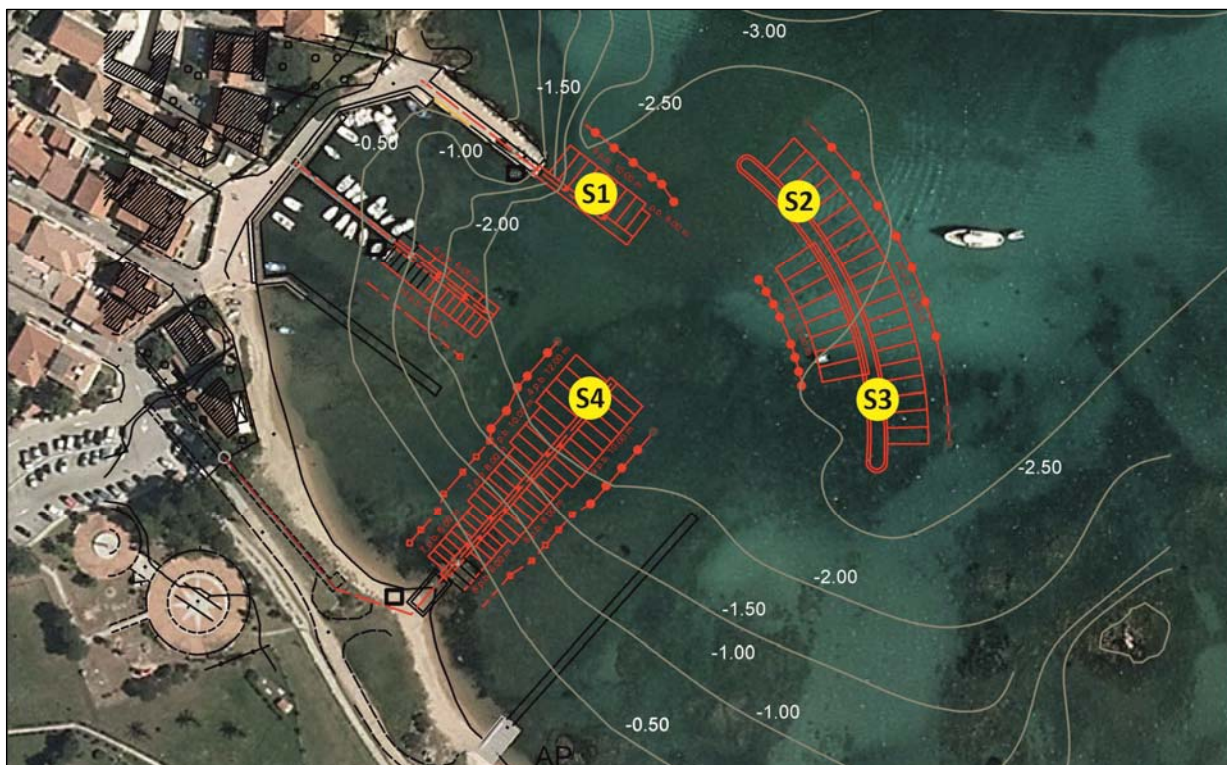
FIGURA 4.1 – Ubicazione dei sondaggi geognostici eseguiti con vibrocarotiere. In giallo il sondaggio dove è stato prelevato il campione
