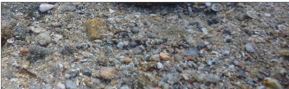
Foto 5.2 - Sedimenti sabbiosi bioclastici grossolani dello Strato A (immagine tratta dalle riprese del fondale)
