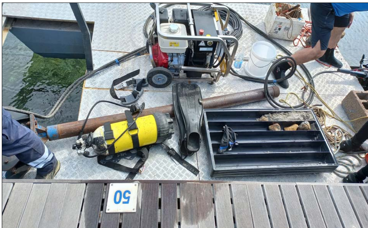
Foto 4.6 – Carotiere per il campionamento dei sedimenti e cassetta catalogatrice
