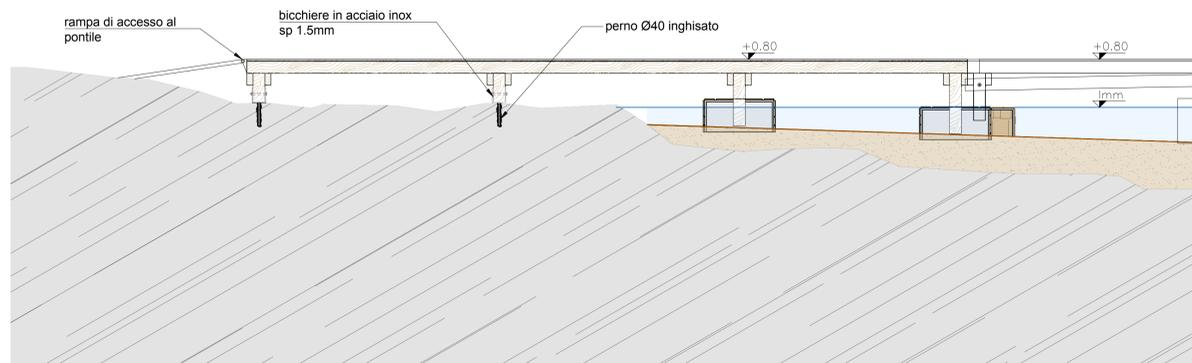
SEZIONE LONGITUDINALE TIPO PONTILE SU PALI
