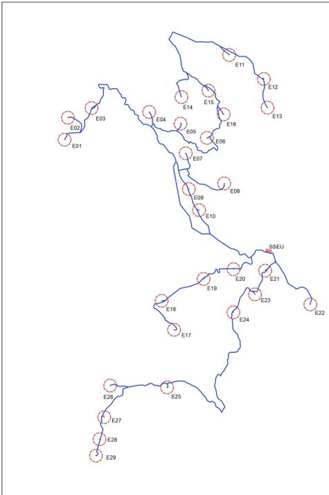
**PROGETTO DEFINITIVO PER LA REALIZZAZIONE DI UN PARCO EOLICO COMPOSTO DA 29 AEROGENERATORI E RELATIVE OPERE CONNESSE CON POTENZA COMPLESSIVA DI 153,9 MW NEI COMUNI DI ESTERZILI (SU), ESCALAPLANO (SU) E SEUI (SU)**
