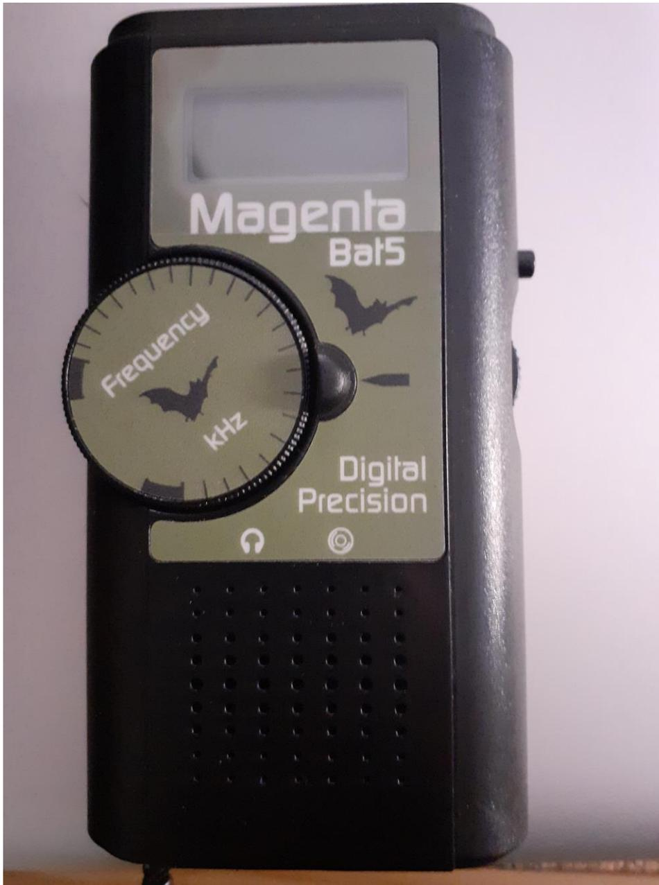
E' stato utilizzato un *bat-detector* “Magenta Bat 5 Superheterodyne”.
