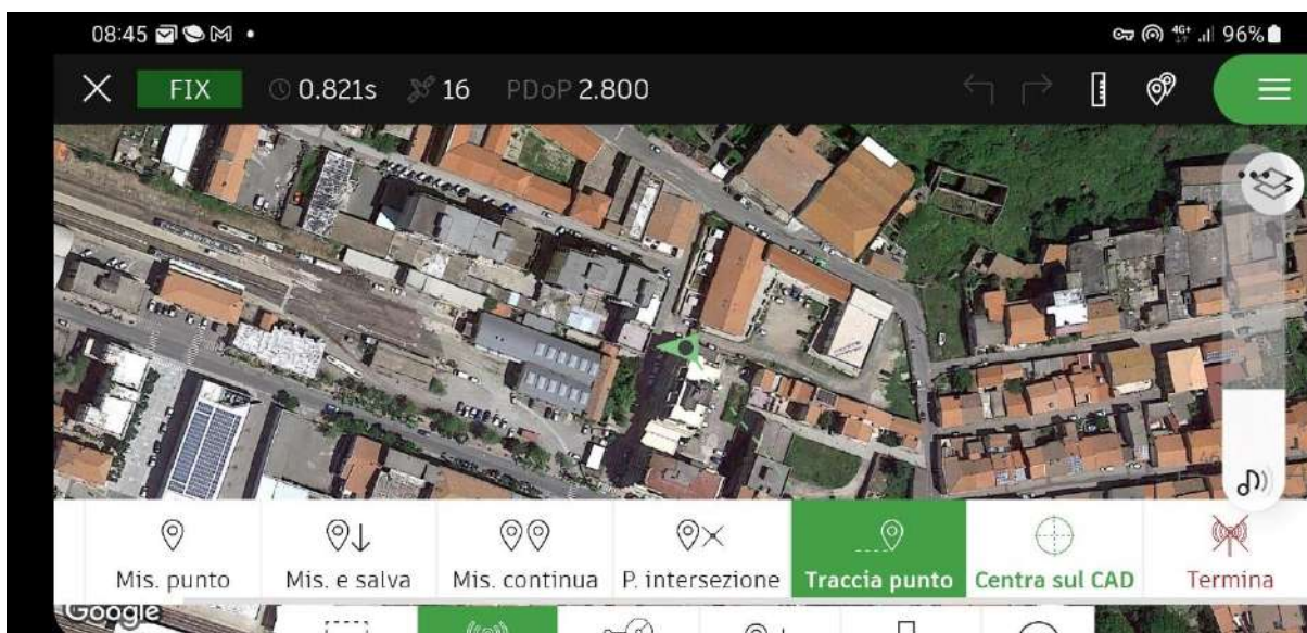
Img 2 – Interfaccia grafica software T-Pad con funzione “Traccia punto” attiva
