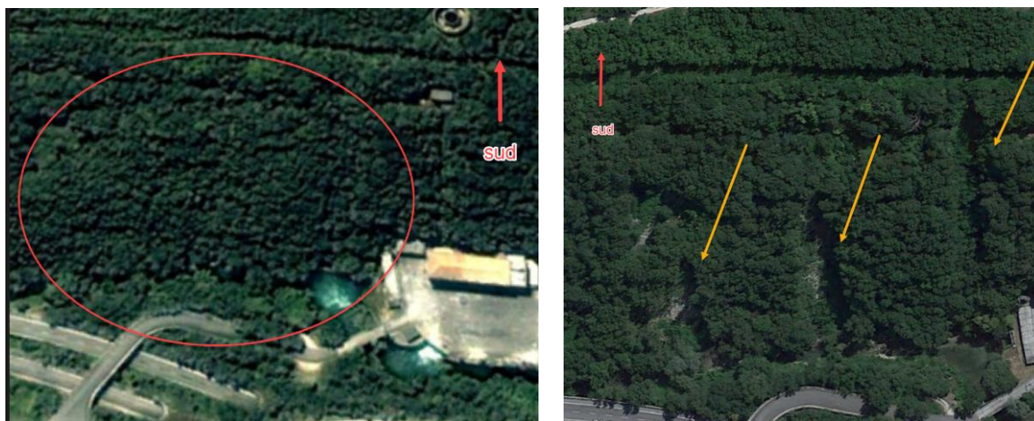
Figura 14: Immagini satellitari del versante nel tratto ad est della centrale (da Google Earth). In alto immagine riferita all'anno 2004, in basso dettaglio del versante nel 2016 con indicate le aree dove si sono sviluppati i dissesti
