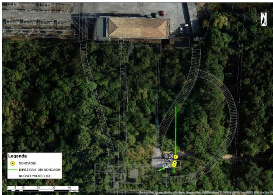
Figura 7: Pianta con indicazione e posizione dei carotaggi sulla nuova centrale di Valcimarra (da: Pietrangeli 2022)[36]
