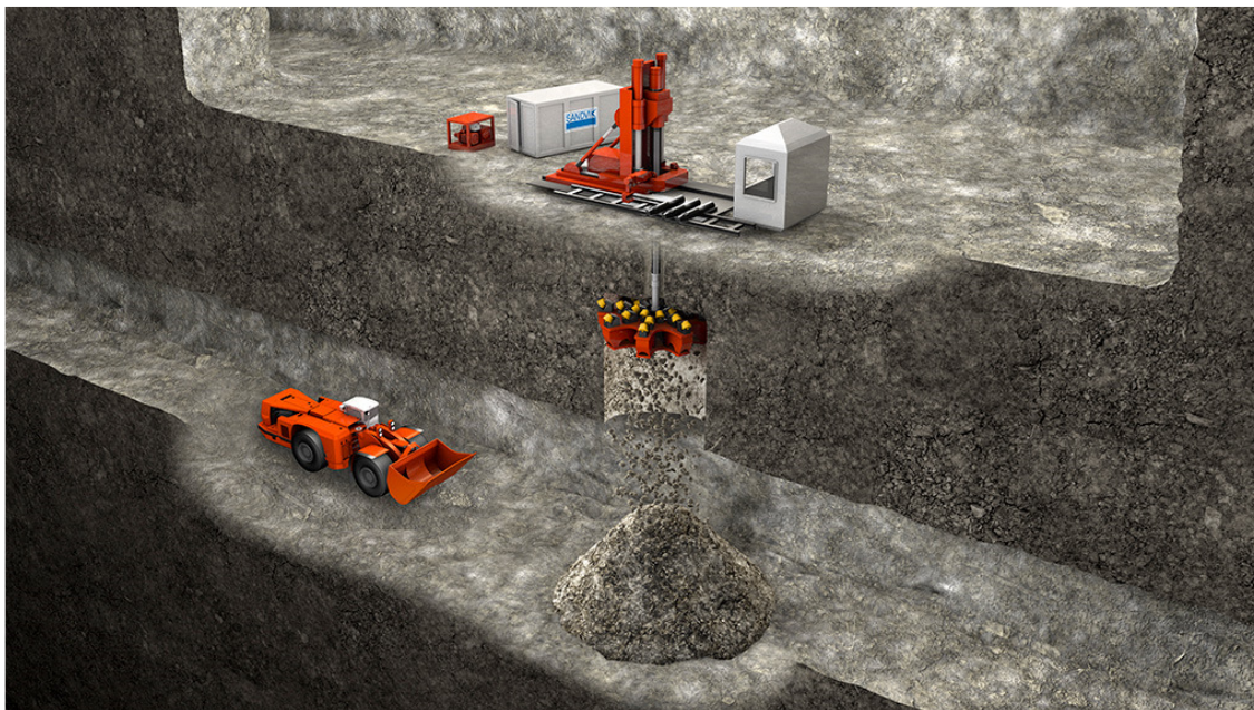
Figura 2: Impianto di Valcimarra Chienti - Equipaggiamento per scavo di pozzi verticali mediante la tecnica del raise boring (raise boring rig)
