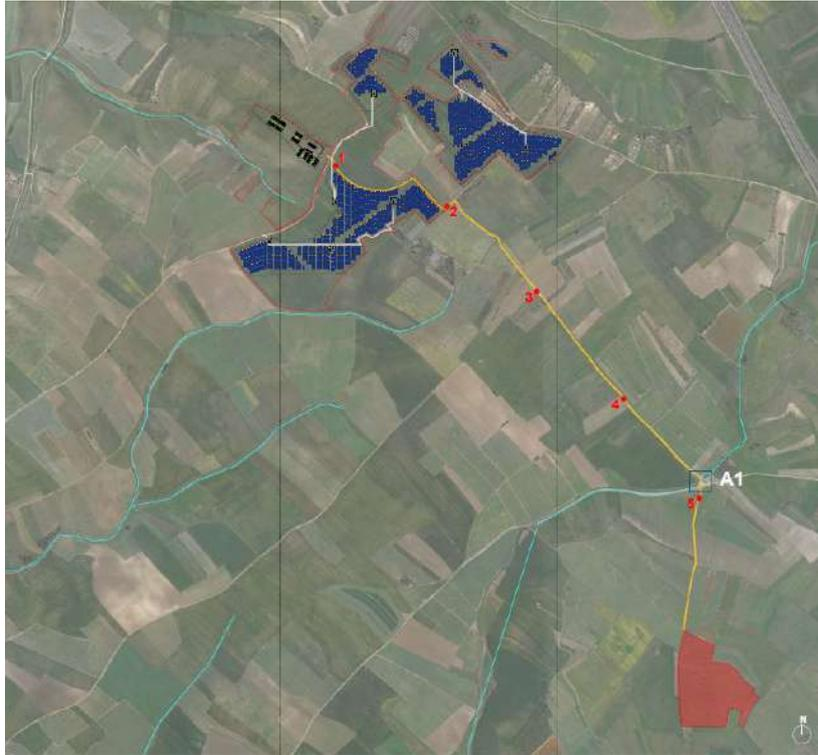
Figura 31: Estratto tav. OS\_09 - In arancione il percorso del cavidotto che incrocia il corpo idrico nell'area A1
