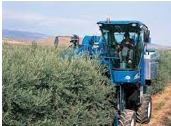
Figura 6 - Scavallatrice per uliveto superintensivo
